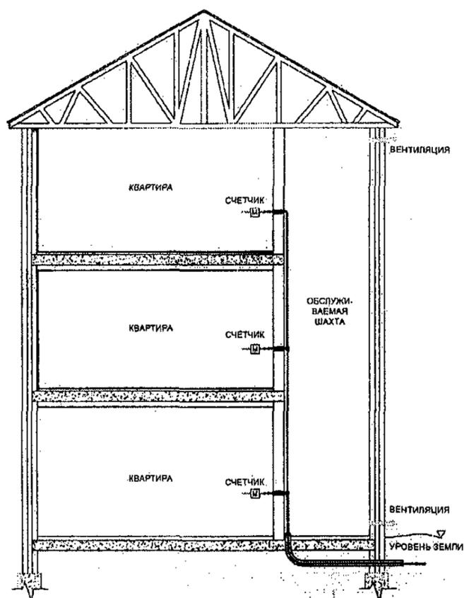
Рисунок Г.2 – Газопровод в вентилируемой шахте
