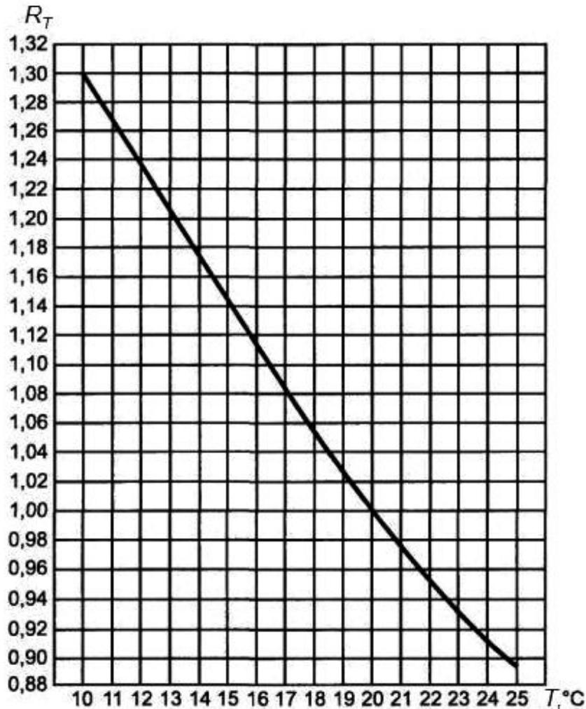
Рисунок ДА.3 - Значения поправочных коэффициентов в зависимости от температуры воды,  $^\circ\text{C}$
