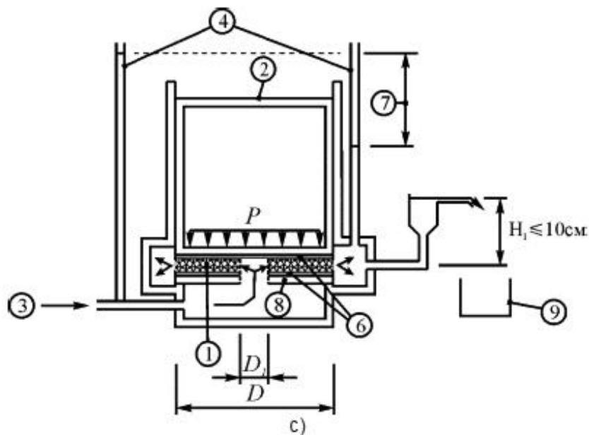
1 - фильтрационная камера длиной  $L$  (диаметром  $D$  для схемы б) с образцом геотекстильного материала; 2 - устройство для передачи давления ( $P$ ) на образец; 3 - устройство для подачи воды; 4 - устройство для измерения напора; 5 - мембрана; 6 - резиновые прокладки; 7 - величина напора; 8 - металлический диск; 9 - емкость для сбора воды
