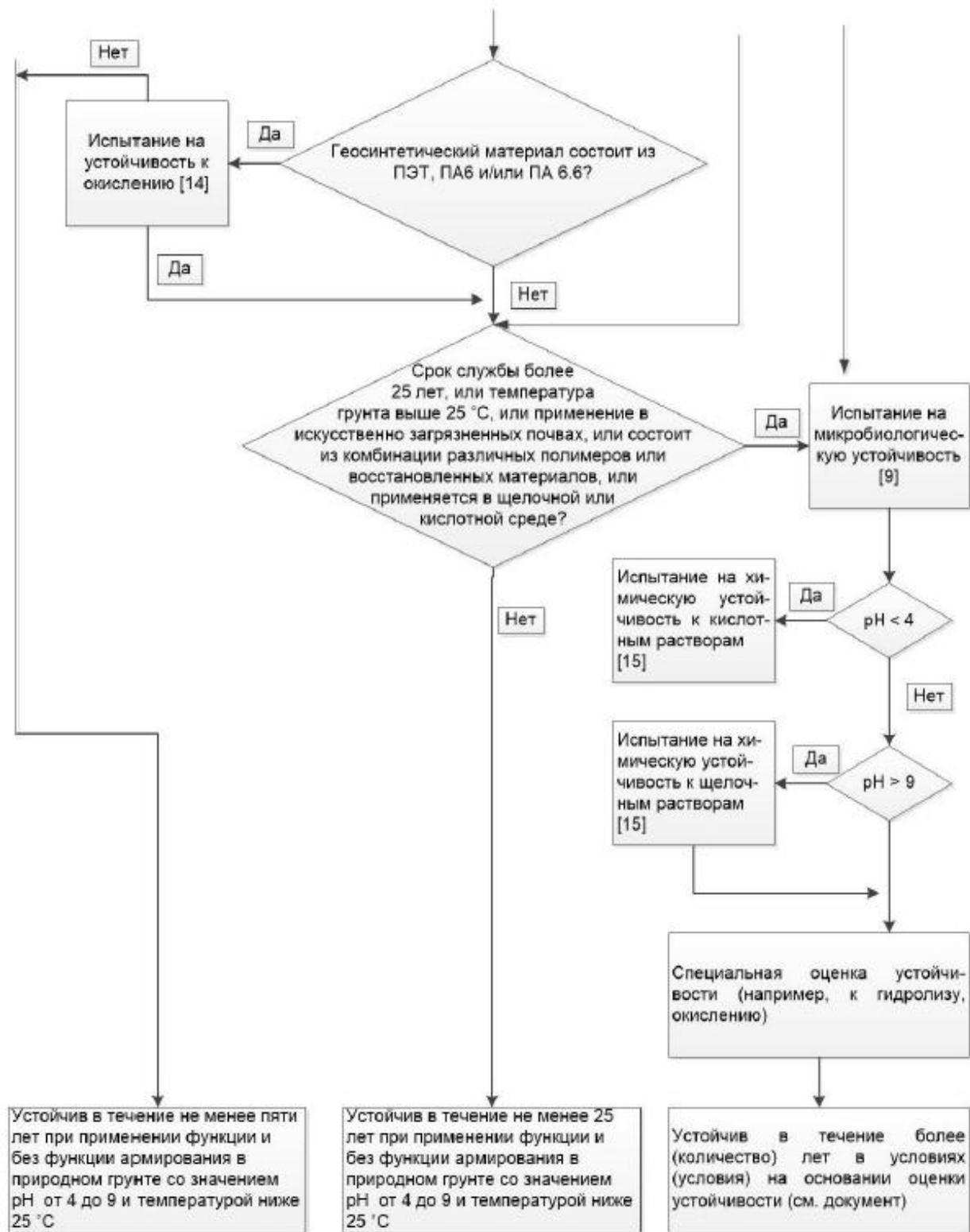
Рисунок D.1 - Структурная схема метода оценки устойчивости
